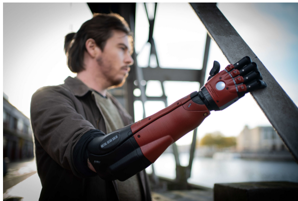
Fig. 2.1: Uno de los Hero Arm desarrollados por OpenBionics, [1]
