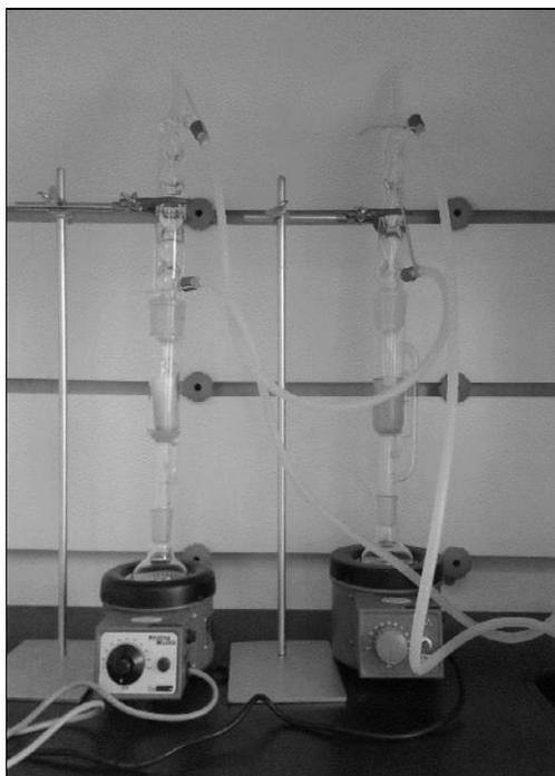
Figura 7: Equipo *Soxhlet* utilizado para la extracción de aceite, para el proceso de caracterización (Ubicado en el Laboratorio de Alta Presión de la UTFSM, Campus San Joaquín).
