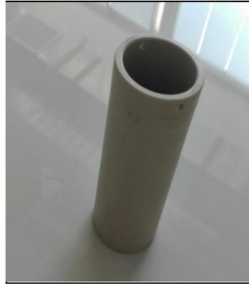
Figura 14: Canasto donde se encuentran las perlas de vidrio en el proceso de extracción supercrítica.
