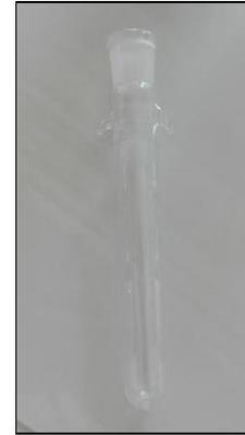
Figura 15: Vial de vidrio donde se recolecta el aceite de microalga extraído
