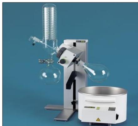
Figura 9: Rotavapor Buchi, modelo R-3 empleado en el procedimiento experimental (Buchi, 2017)
