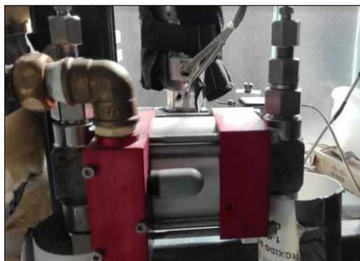
Figura 27: Bomba Neumática correspondiente al equipo de extracción supercrítica
