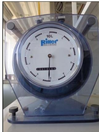
Figura 16: Flujómetro marca Ritter, modelo TG 10, empleado en el proceso experimental.
