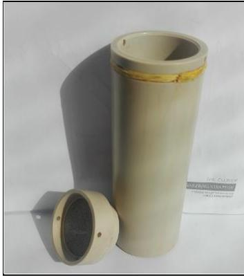
Figura 13: Canasto donde se encuentra el lecho de microalgas en el proceso de extracción supercrítica
