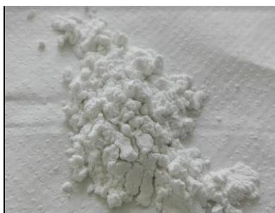
Figura 6: Oxido de Aluminio (Alúmina) empleada en el cálculo de porosidad de lecho.
