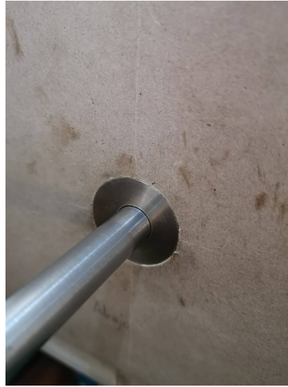
(b) Buje de bronce diseñado y torneado específicamente para suplir buje original.
