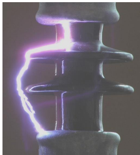
Figura 6. Flashover en superficie de aislador (Chrz, 2009)
