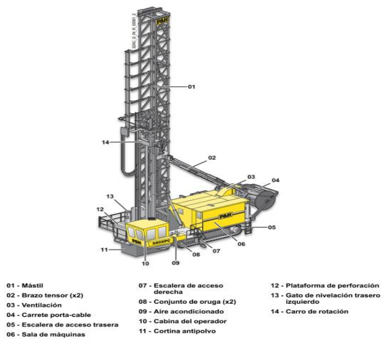
Figura 1-5. Diagrama general de la perforadora P&H 320 XPC.
