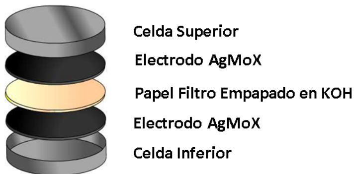
Figura 3.2. Secuencia de ensamblaje de la celda tipo coin cell CR2032.
