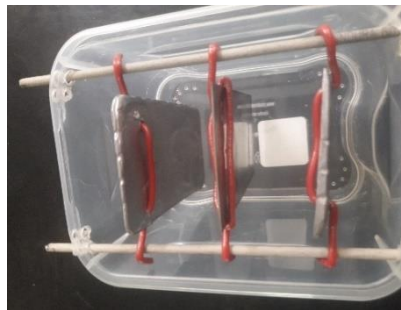
Figura 3-3. Disposición de las placas en la celda vista de forma horizontal.
