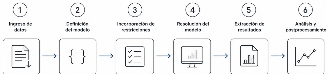
Figura 5.7: Diagrama resumen de la implementación computacional y resolución del modelo de TEP.
