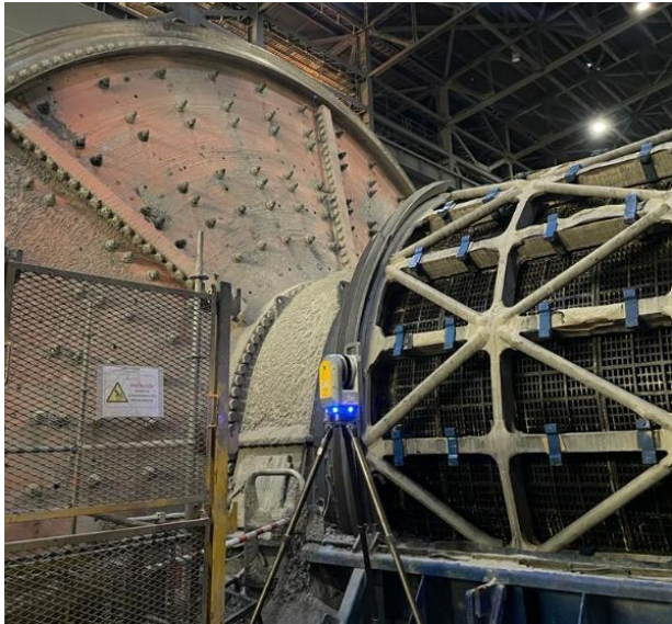
Figura 2-1. Levantamiento 3D a distancia con escáner laser Trimble X7
