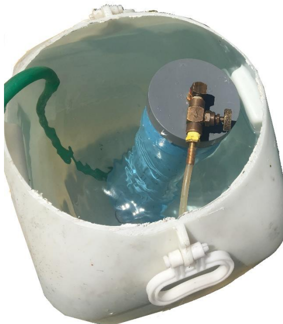
Ilustración 25: Sistema de acumulación de gases con trampa de agua.
