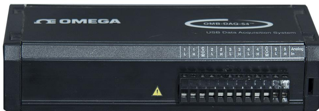
Ilustración 29: Adquisidor de datos Omega OMB-DAQ-54.
