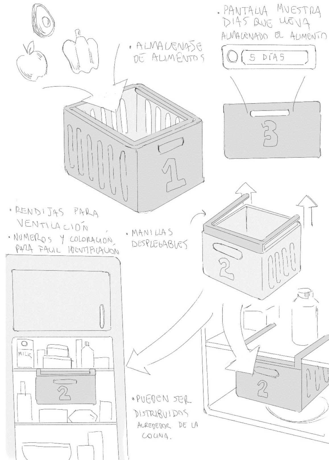
FIG 32: MÓDULOS DE ALMACENAMIENTO
