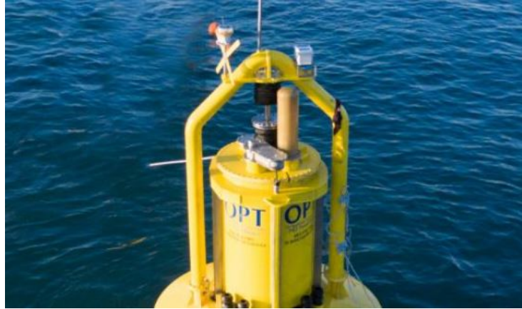
Figura 1.11: Boya tipo Power Buoy, convertidor de energía marina a escala real, Chile (Ministerio de Energía, Chile, 2021).
