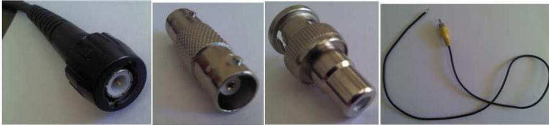
**Fig. 4.22** Conexión de puntas de corriente y voltaje para adquisidor de datos.
