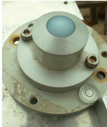
**Fig. 4.7 Piranómetro de silicio disponible en Laboratorio de Energías Renovables**
