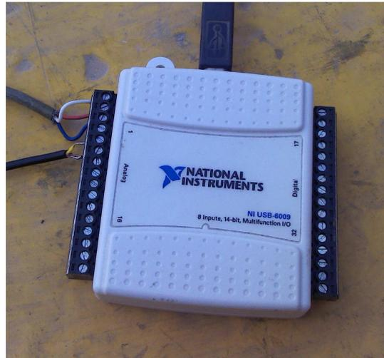
**Fig. 4.12** Adquisidor de datos NI USB-6009 disponible en LER.
