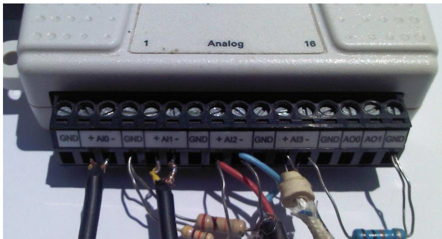
**Fig. 4.13** Entradas analógicas del adquisidor de datos
