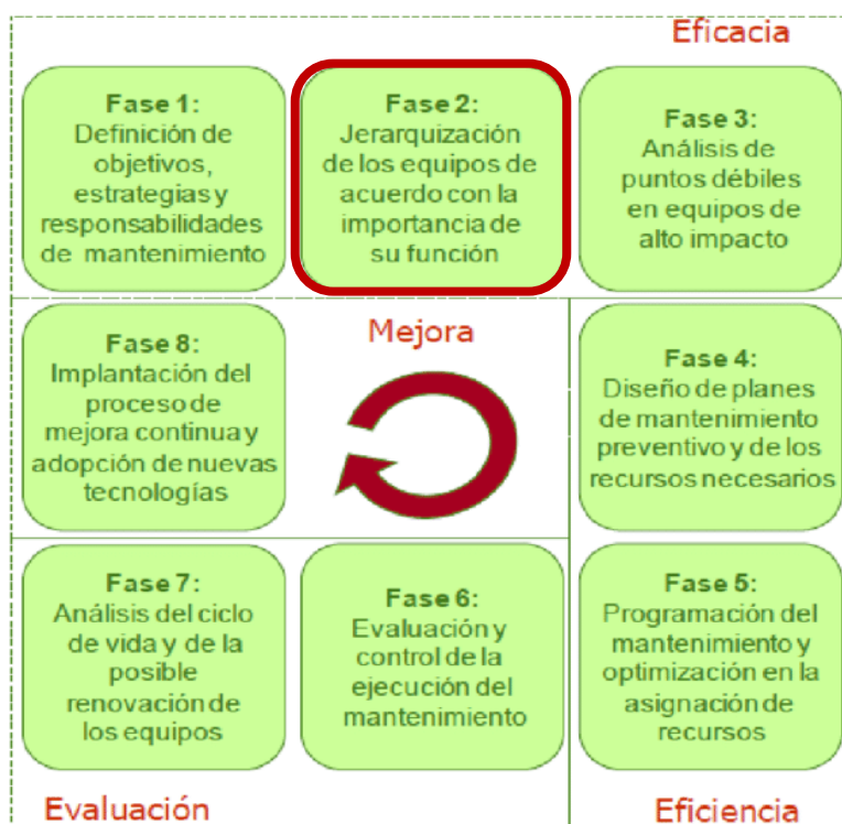
Figura 1.3-1: Modelo de Gestión del Mantenimiento Fuente: Modelo de Gestión del Mantenimiento propuesto (MGM) (Parra y Crespo, 2012)
