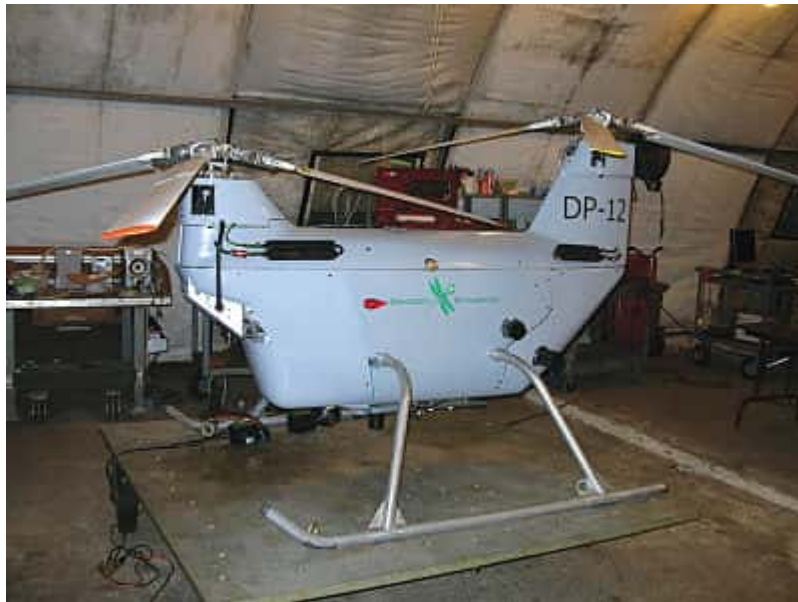
Figura 10: Drone con dos rotores en configuración tándem Ref: (Perez)
