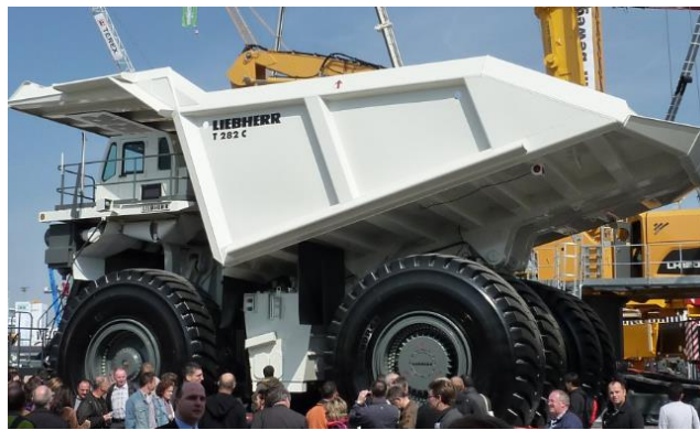
Figura 24: Dumper marca Liebherr T282-C.
