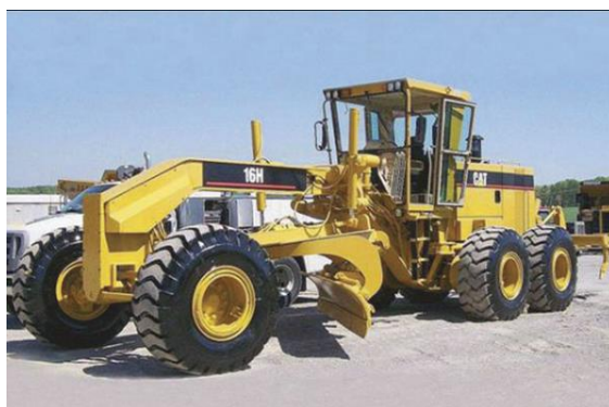
Figura 32: Motoniveladora Caterpillar 16 H.
