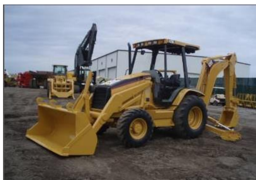
Figura 36: Retroexcavadora Caterpillar 420D.
