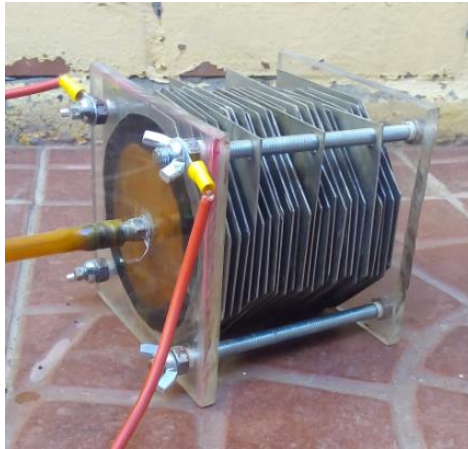
Figura 2-17. Generador tipo seco modificado para aumentar su producción.
