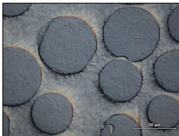
Figura 2.4: Recubrimiento de matriz NiBSi reforzada con carburos de tungsteno fundido WC_{1-x} de morfología esferoidal [1].
