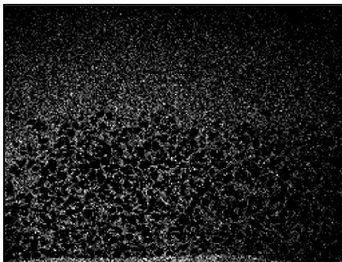
Figura 4.32: Análisis EDS por área de fierro de la sección transversal observada en la Figura 4.26, magnificación de x54.
