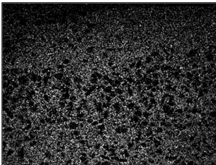
Figura 4.14: Análisis EDS por área de hierro de la sección transversal observada en la Figura 4.8, magnificación de x54.
