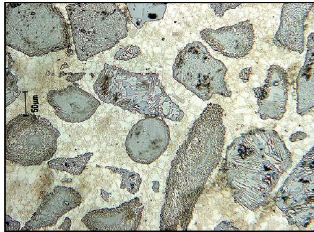
Figura 1.3: Microestructura de recubrimiento duro de matriz NiBSi reforzada con carburos de tungsteno fundido de morfología angular afectados por disolución [10].
