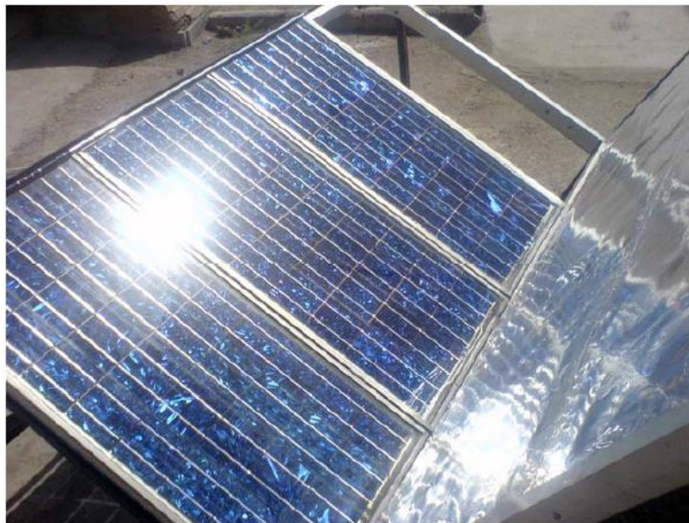
Figura 10: Configuración panel reflector con reflector de aluminio. 3 paneles de 45 [W] [17].
