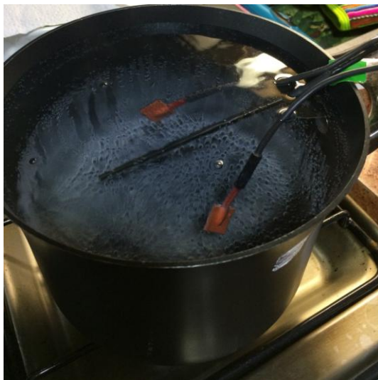
Figura 22: Termocuplas 1 y 2 sumergidas en agua destilada junto a la termocupla ambiental (T7)
