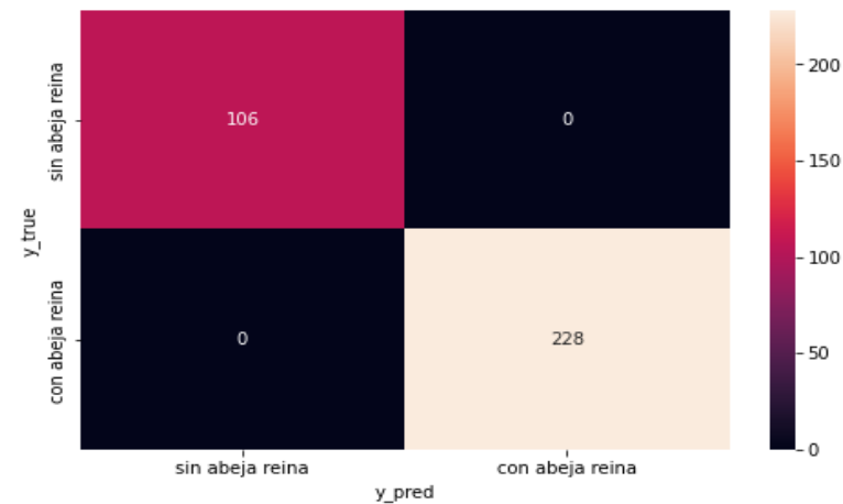
Figura 52: Matriz de confusión generada por el primer modelo descrito en 3.2.7. Métrica usada accuracy , número de épocas 72, 40 MFCCs, dataset 1 [s], 4 capas Conv2D + MaxPooling2D + Dropout . (mfcc 20). Fuente: Elaboración propia.
