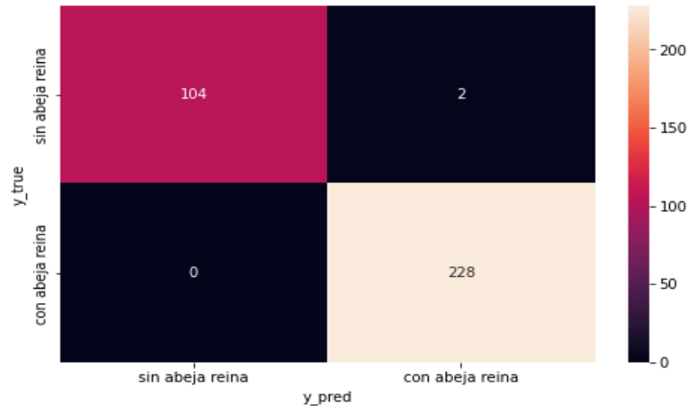
Figura 67: Matriz de confusión generada por el primer modelo descrito en 3.2.7. Métrica usada accuracy , número de épocas 72, 40 MFCCs, dataset 1 [s], 4 capas Conv2D + MaxPooling2D + Dropout . (mfcc 20). Fuente: Elaboración propia.
