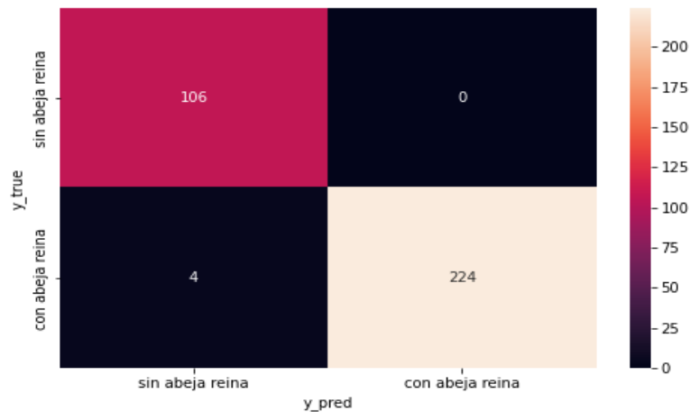
Figura 66: Matriz de confusión generada por el primer modelo descrito en 3.2.7. Métrica usada accuracy , número de épocas 72, 40 MFCCs, dataset 1 [s], 3 capas Conv2D + MaxPooling2D + Dropout . (mfcc 13). Fuente: Elaboración propia.
