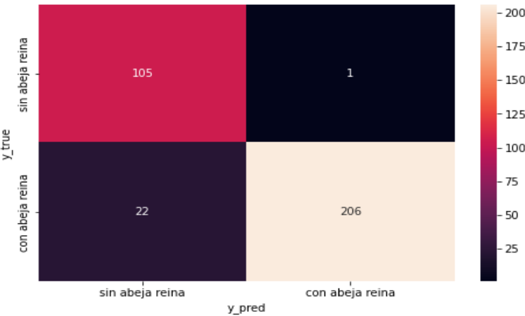
Figura 43: Matriz de confusión generada por el segundo modelo descrito en 3.2.7. Métrica usada accuracy , número de épocas 72, dataset 1 [s], 3 capas Conv2D + MaxPooling2D + Dropout . (mfcc 13). Fuente: Elaboración propia.
