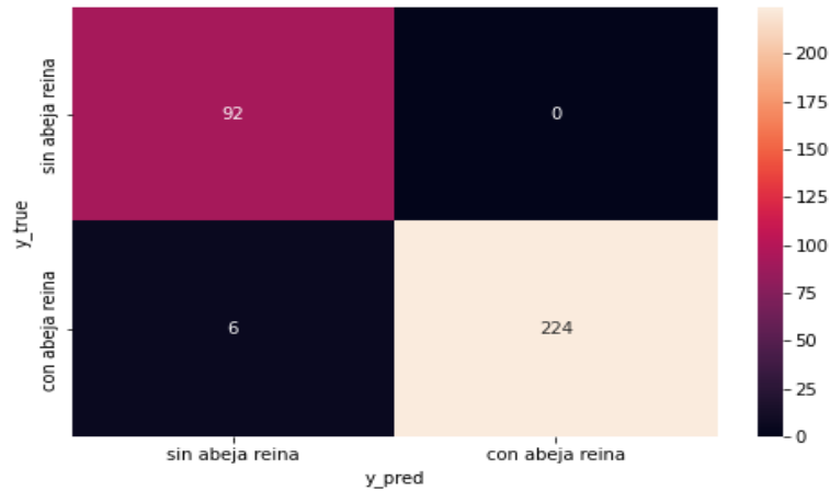
Figura 46: Matriz de confusión generada por el primer modelo descrito en 3.2.7. Métrica usada accuracy , número de épocas 72, dataset 3 [s], 4 capas Conv2D + MaxPooling2D + Dropout . (mfcc 20). Fuente: Elaboración propia.
