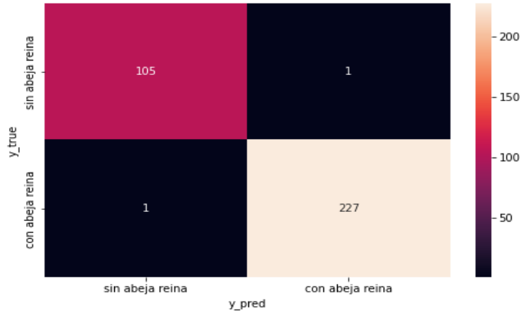
Figura 49: Matriz de confusión generada por el primer modelo descrito en 3.2.7. Métrica usada accuracy , número de épocas 72, 20 MFCCs, dataset 1 [s], 3 capas Conv2D + MaxPooling2D + Dropout . (mfcc 13). Fuente: Elaboración propia.
