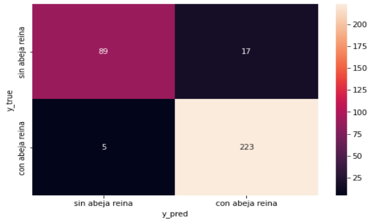
Figura 40: Matriz de confusión generada por el primer modelo descrito en 3.2.7. Métrica usada accuracy , número de épocas 72, 4 capas Conv2D + MaxPooling2D + Dropout . (mfcc 20). Fuente: Elaboración propia.
