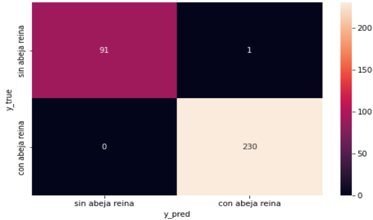
Figura 61: Matriz de confusión generada por el primer modelo descrito en 3.2.7. Métrica usada accuracy , número de épocas 72, 40 MFCCs, dataset 3 [s], 3 capas Conv2D + MaxPooling2D + Dropout . (mfcc 13). Fuente: Elaboración propia.
