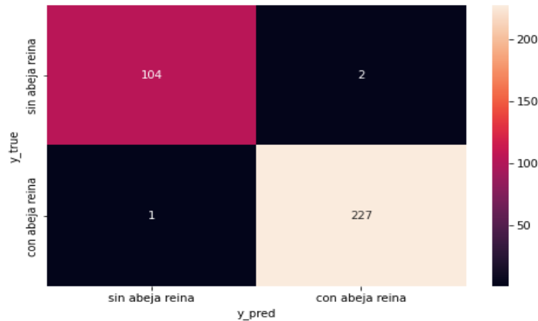
Figura 65: Matriz de confusión generada por el primer modelo descrito en 3.2.7. Métrica usada accuracy , número de épocas 72, 20 MFCCs, dataset 1 [s], 4 capas Conv2D + MaxPooling2D + Dropout . (mfcc 20). Fuente: Elaboración propia.
