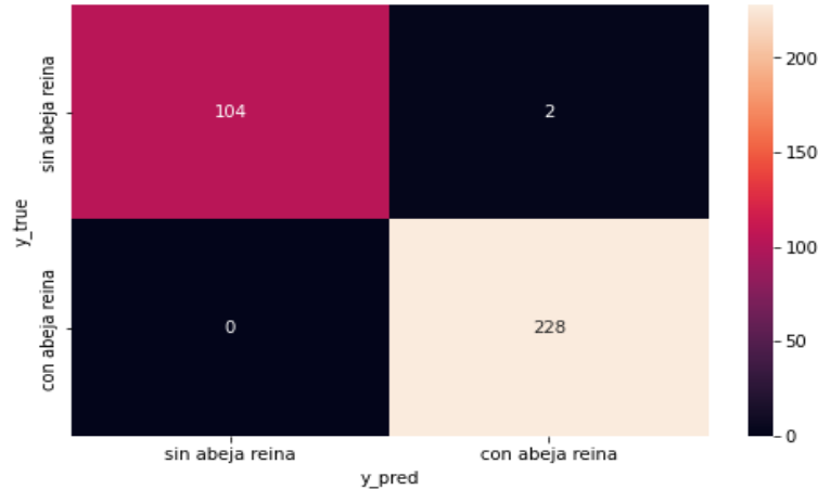
Figura 63: Matriz de confusión generada por el primer modelo descrito en 3.2.7. Métrica usada accuracy , número de épocas 72, 13 MFCCs, dataset 1 [s], 3 capas Conv2D + MaxPooling2D + Dropout . (mfcc 13).
