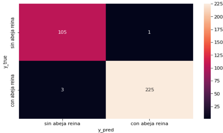
Figura 64: Matriz de confusión generada por el primer modelo descrito en 3.2.7. Métrica usada accuracy , número de épocas 72, 20 MFCCs, dataset 1 [s], 3 capas Conv2D + MaxPooling2D + Dropout . (mfcc 13).
