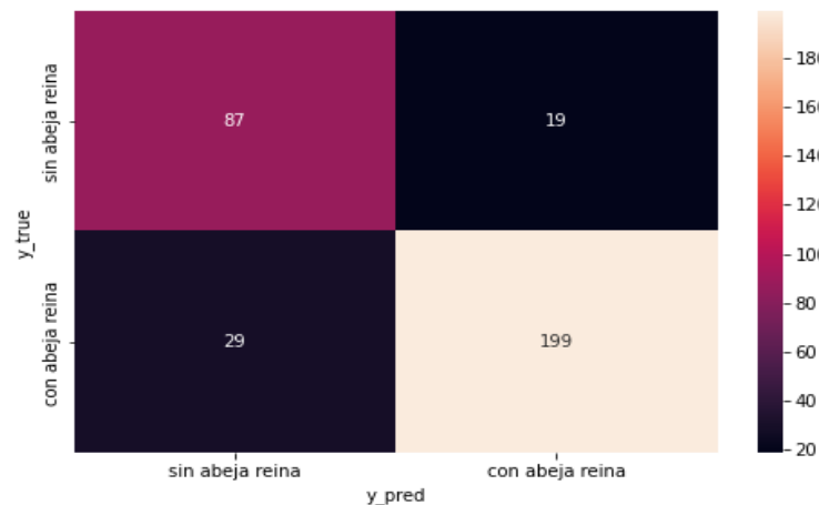
Figura 41: Matriz de confusión generada por el segundo modelo descrito en 3.2.7. Métrica usada accuracy , número de épocas 72, 3 capas Conv2D + MaxPooling2D + Dropout . (mfcc 13). Fuente: Elaboración propia.
