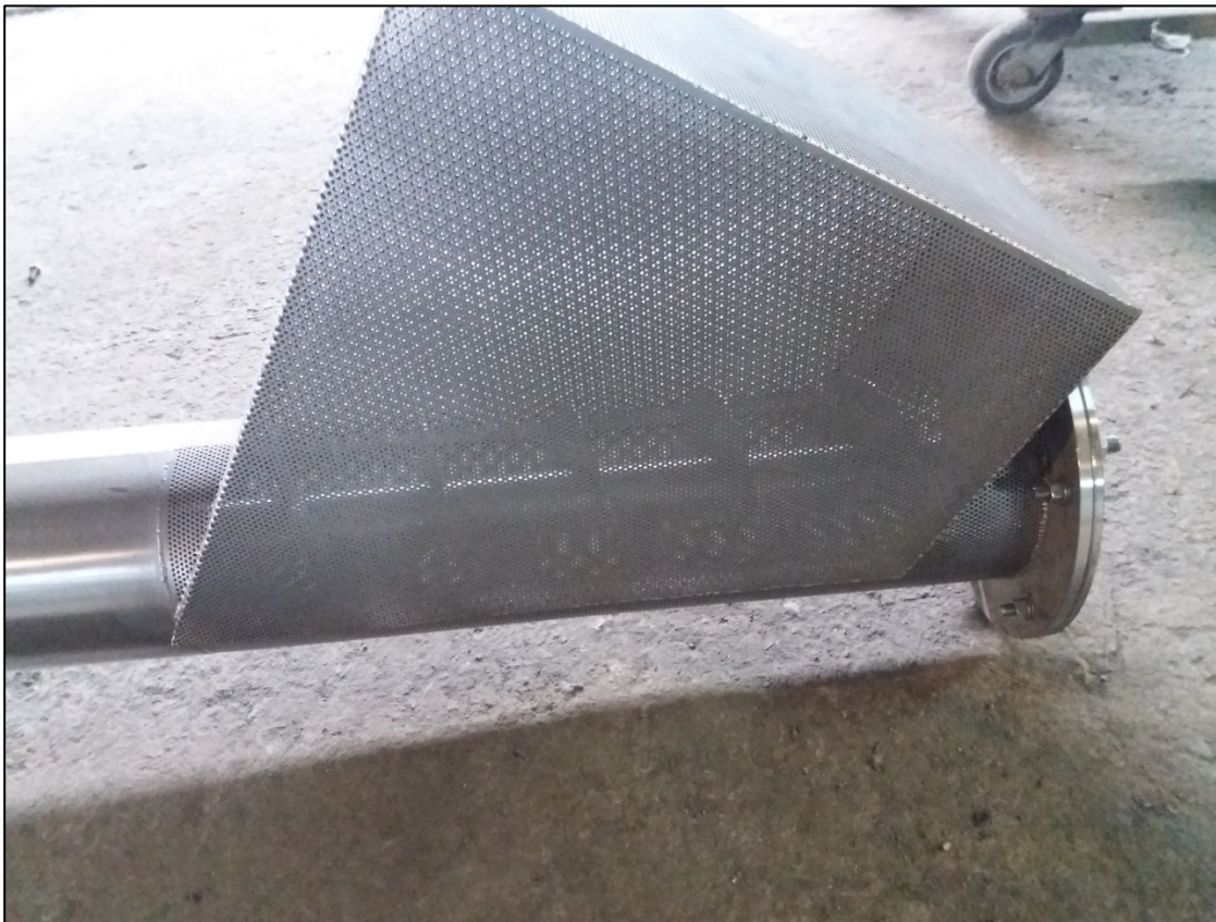
Figura 106: Fotografía - Tolva de recepción perforada.
