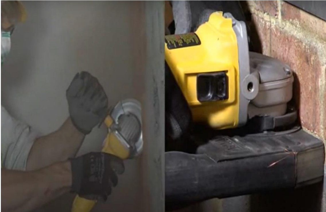
Anexo 7: Guarda extractora de polvo para esmeril angular
