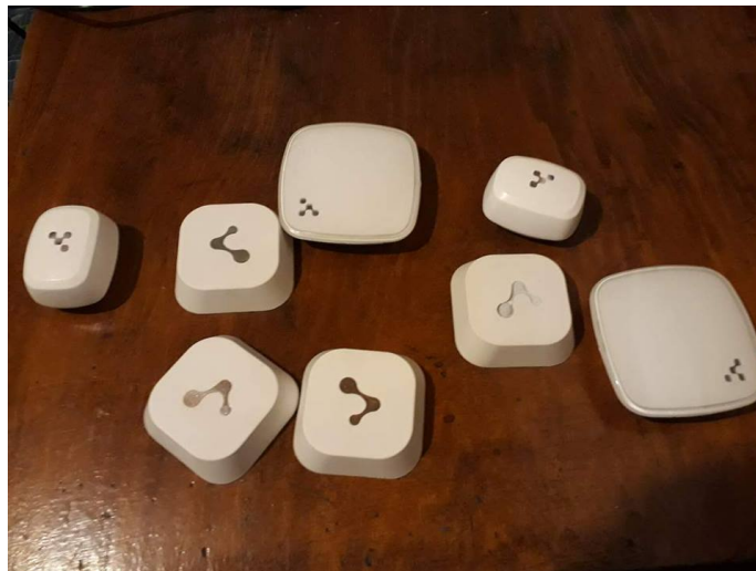
Figura 5.1: Diferentes tipos de Beacons utilizados en la experimentación (Fuente: Elaboración propia)
