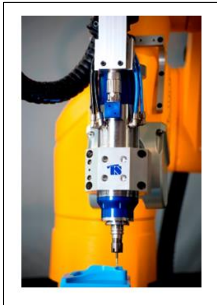
Ilustración 7: Actuador de tipo herramienta equipado con una fresadora
