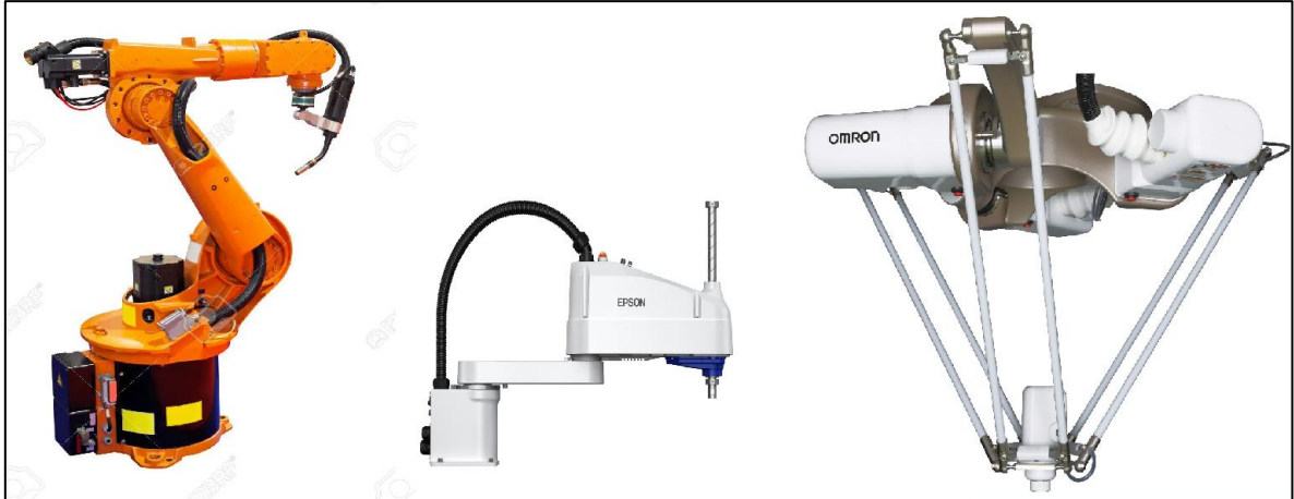
Ilustración 2: Brazos roboticos, tipo Normal, Scara y Delta
