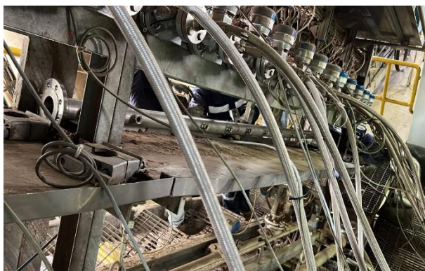
Figura 50. Flexible metálico semirrígido de agua/resina (Riquelme A., Figura de flexibles agua/resina UF, 2024)
