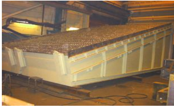
Figura 17. Parrillas Transportadoras de material combustible (Riquelme A., Figura de parrillas transportadoras, 2024)
