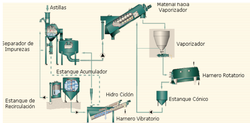
Figura 11. Proceso de lavado de astillas (Projector Macromedia, Figura de proceso de lavado de astillas, 2024)
