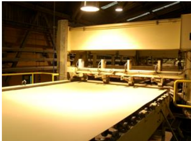
Figura 55. Proceso de corte con sierras volantes (Riquelme A., Figura de proceso de corte con sierras volantes, 2024)
