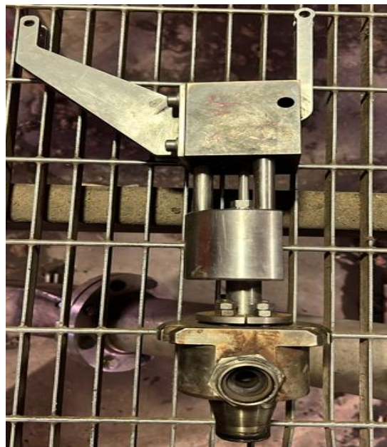
Figura 41. Inyector de resina (Riquelme A., Figura de inyector de resina, 2024)
