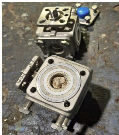
Figura 46. Válvula de bola de 3 vías tipo L (Riquelme A., Figura de válvula de bola de 3 vías tipo L, 2024)
