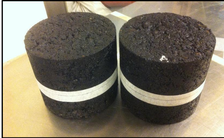
Figura 3-10: Demarcación de probetas para posterior corte.
