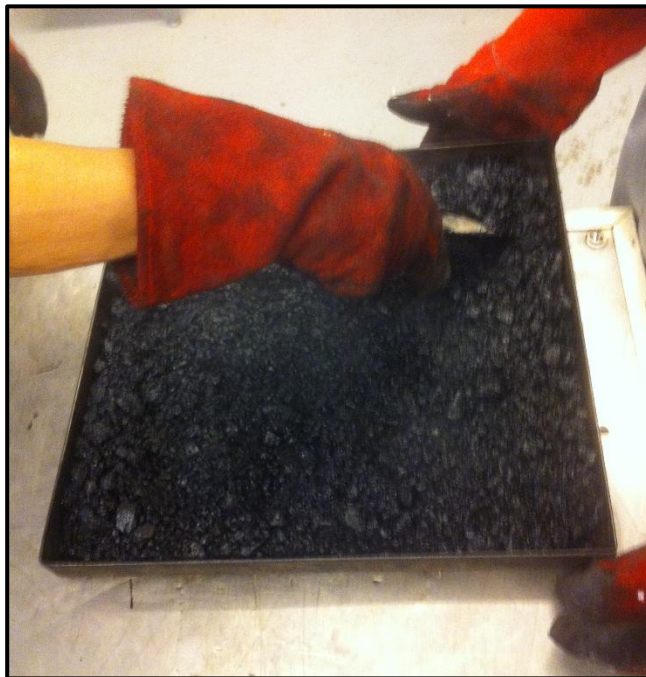
Figura 3-4: Colocación de mezcla en bandeja.
