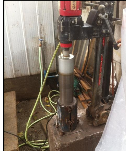
Figura 3-14: Probeta cilíndrica compactada (izquierda) y testiguera en funcionamiento (derecha).
