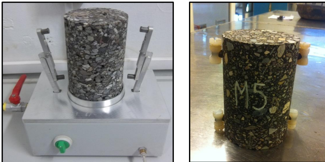
Figura 3-16: Probeta sobre dispositivo (izquierda) y probeta con topes y soportes plásticos (derecha).
