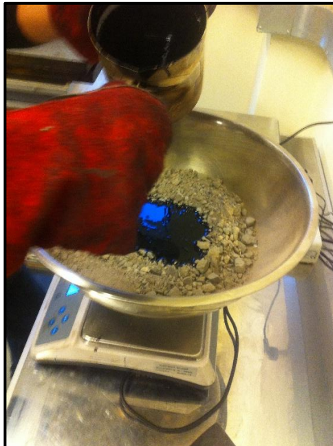
Figura 3-3: Incorporación de ligante asfáltico a mezcla.
