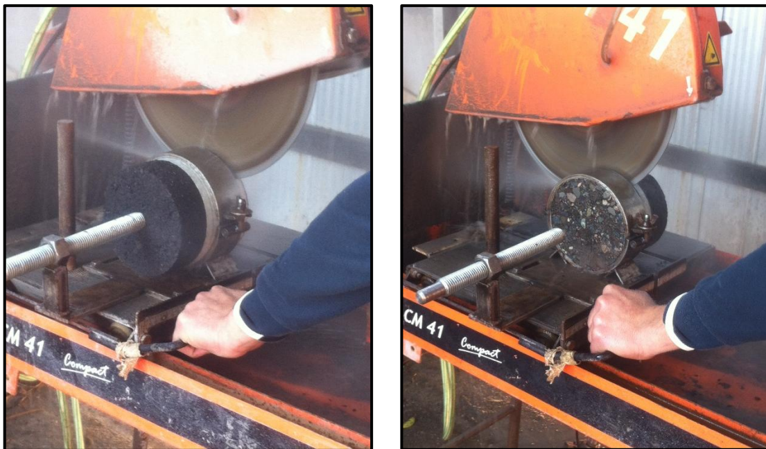
Figura 3-11: Corte de probetas con sierra diamantada.
