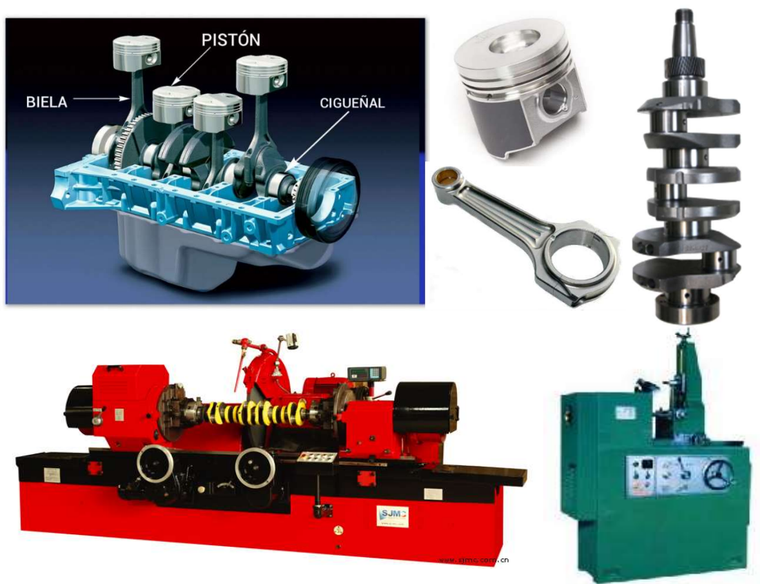
Imágenes referenciales de Cigüeñal, Bielas y la maquinaria necesaria para su rectificación
