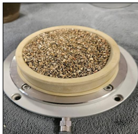
Figura 7. Montaje del ensayo DSS: (izquierda) vista lateral del equipo con anillos de confinamiento y pistón de carga; (derecha) vista superior del espécimen de arena compactado previo al ensayo.
