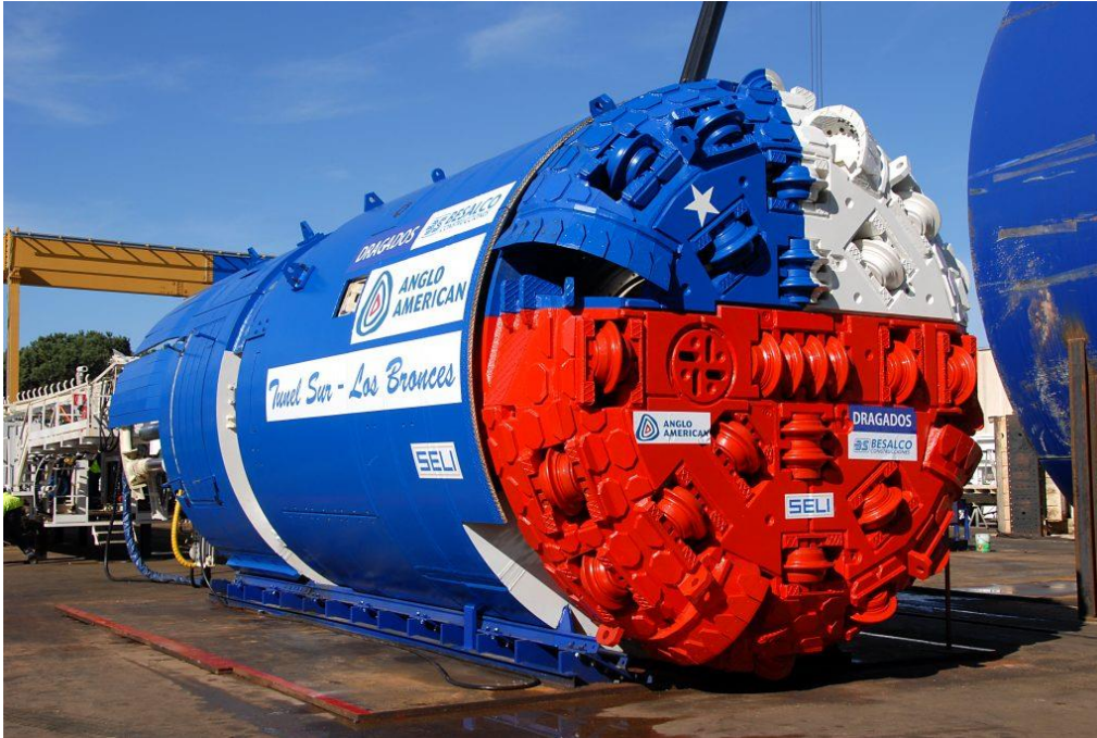
Figura 1.1: TBM utilizada para construir un túnel en los Bronces.
