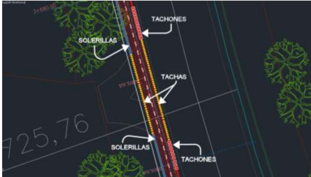
Figura 2-29: Detalle de ubicación de tachas y tachones para ciclovía.
