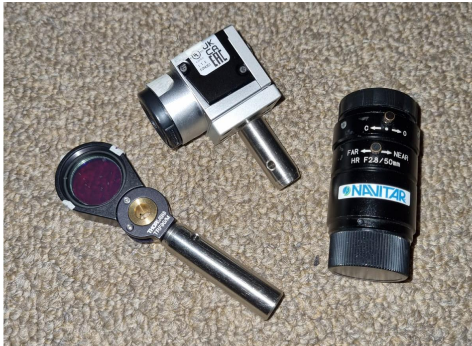
Figura 8: Cámara Basler, lente NAVITAR y filtro utilizado para la experimentación.
