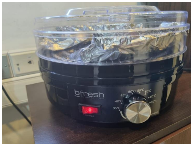
Figura 13: Deshidratador de alimentos utilizado en reemplazo del horno de precisión de secado.
