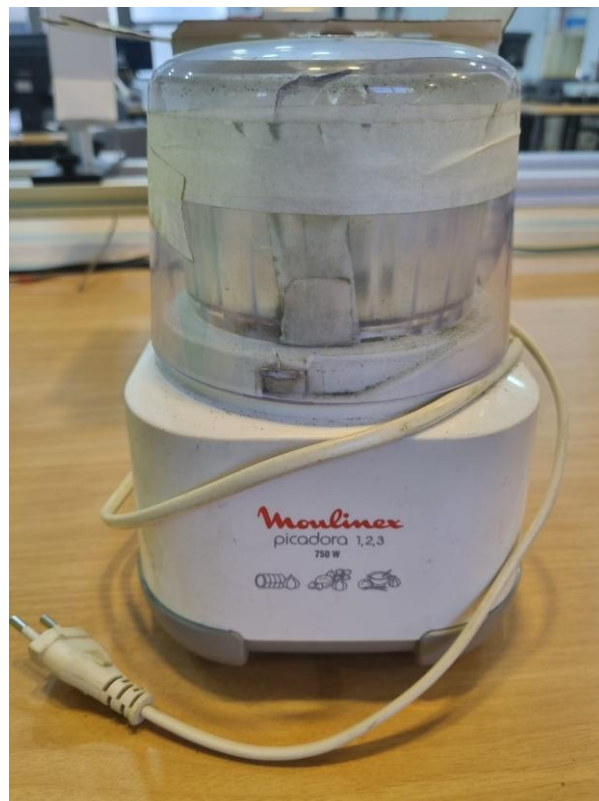
Figura 12: Picadora 1, 2, 3 marca Moulinex de 750 W, utilizada para picar el Eucaliptus.
