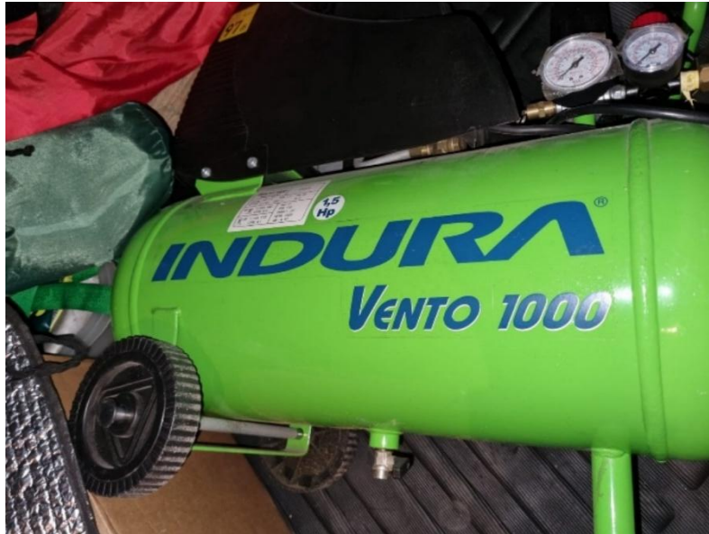
Figura 10: Compresor Indura Vento 1000 de 1,5 hp utilizado en la experimentación.
