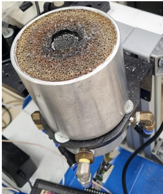
Figura 9: Quemador con estructura cilíndrica de aluminio, montado con el portamuestras de 3,0 cm de diámetro.
