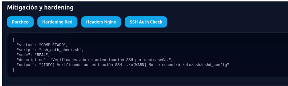
Figura 4.12: Ejecución de script de remediación automática para verificación de autenticación SSH (Fuente: Elaboración propia)
