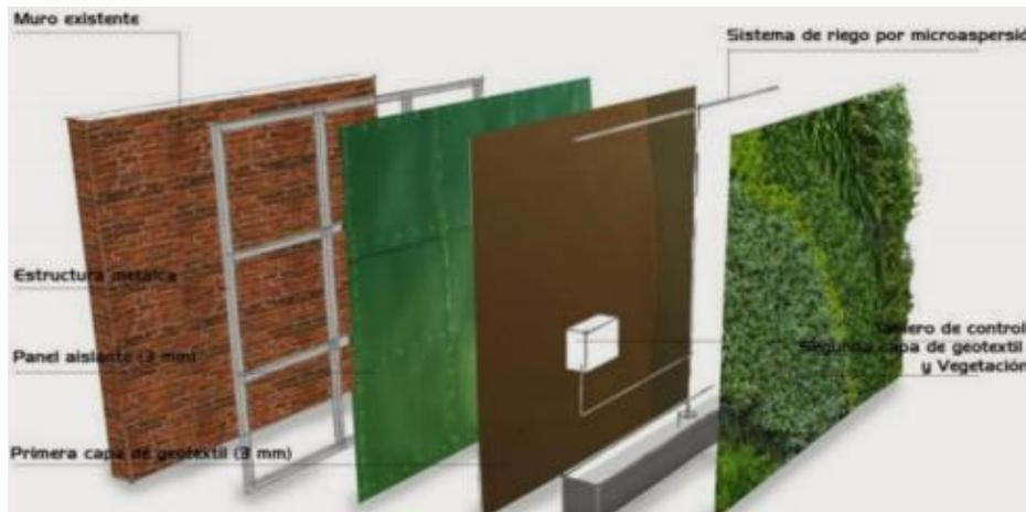
Figura 23. Detalle del ensamblaje por capas del sistema hidropónico.
