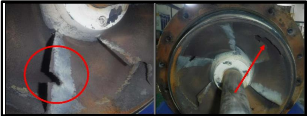
Figura 2-7: Impulsores con roturas
