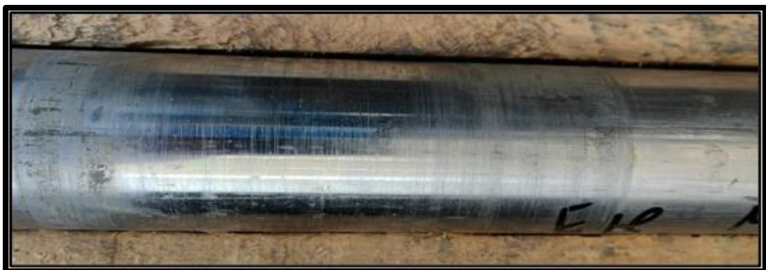
Figura 2-5: Desgaste producidos en centradores
