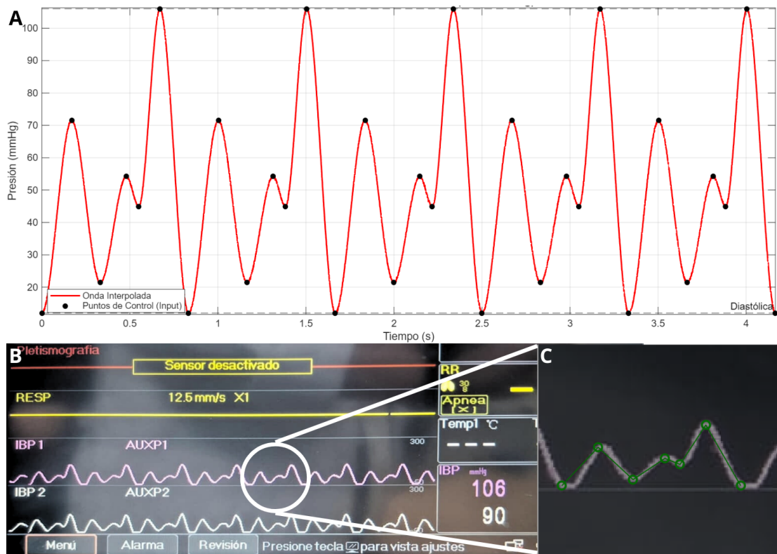
Figura 3.4: Validación de la reconstrucción de señal. (A) Curva interpolada resultante superpuesta a los puntos de control, demostrando el ajuste exacto del algoritmo. B) Curvas de presión sanguínea medida invasivamente. C) Detalle de selección de puntos clave sobre la imagen del monitor. Fuente: Creación propia.
