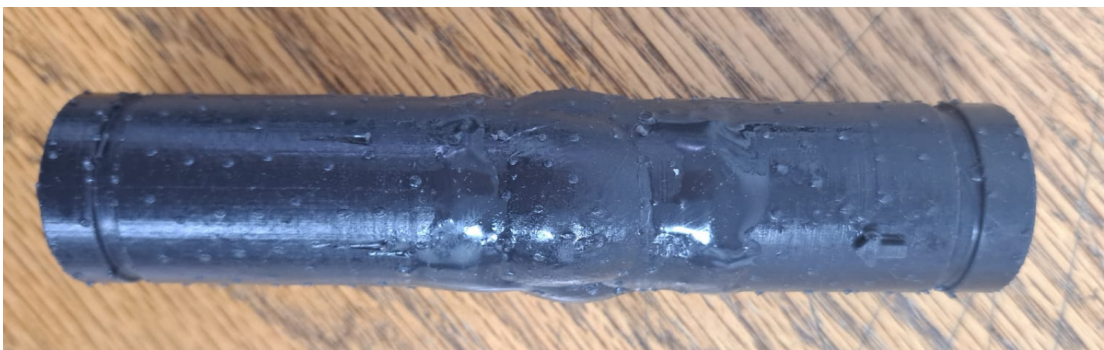
Figura 3.1: Vista general del modelo final de válvula aórtica (Iteración 2) fabricado en Silicona 40A. Fuente: Creación propia.
