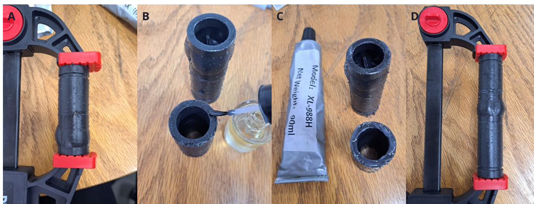
Figura 2.7: Proceso de ensamblado del modelo de válvula. A) Ensamble zona valvar-entrada, B) Aplicación de imprimante XL-2013, C) aplicación de adhesivo XL-998h, D) Ensamble modelo completo. Fuente: Creación propia.
