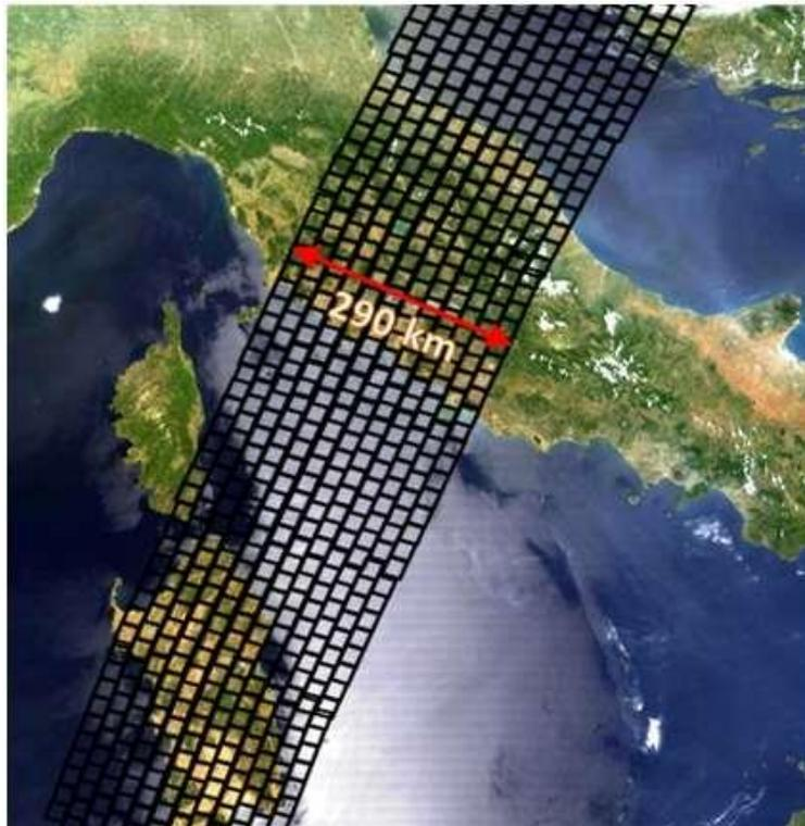
Figura 3–12: Órbita típica que muestra la disposición de los Granules del producto Level-1B. Ancho de franja de 290 km.
