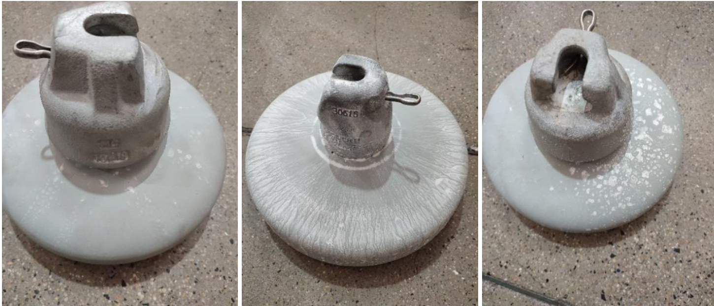
a) Aislador bajo contaminación E1. b) Aislador bajo contaminación E4. c) Aislador bajo contaminación E5.
