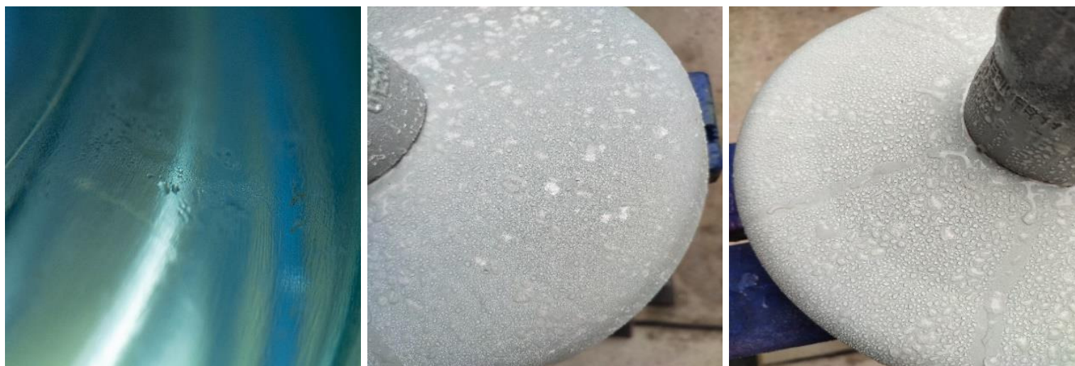
a) Aislador sin recubrimiento.
