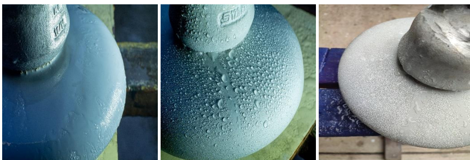
a) Aislador sin recubrimiento.
