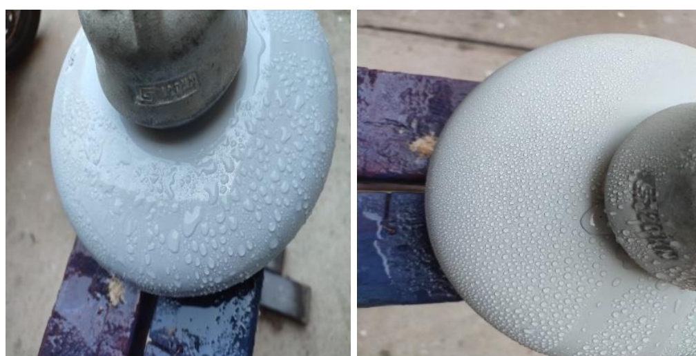
a) Aislador sin recubrimiento.
