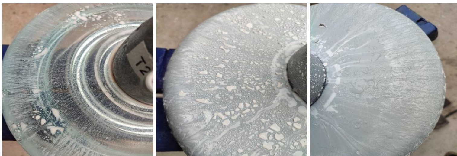
a) Aislador sin recubrimiento.
