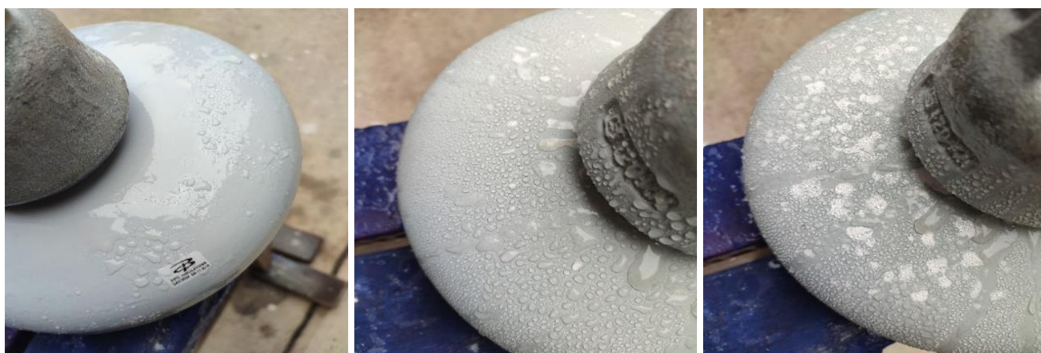
a) Aislador sin recubrimiento.
