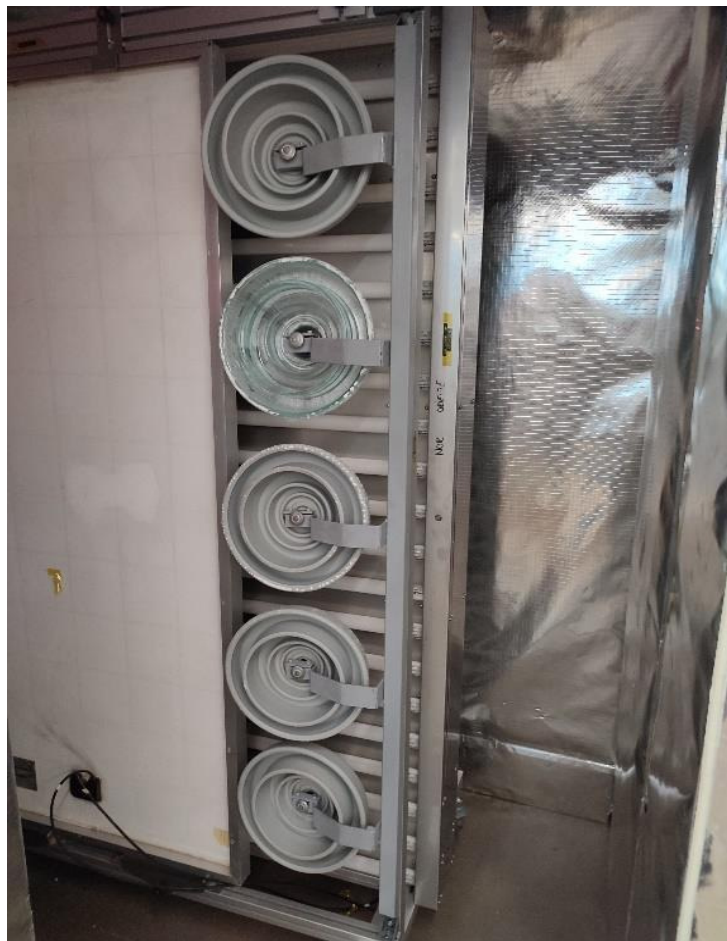
Figura 14: Disposición de los aisladores en cámara de envejecimiento.
