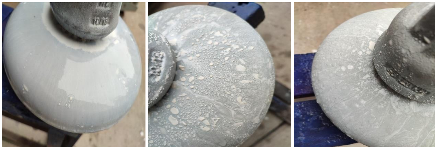
a) Aislador sin recubrimiento.
