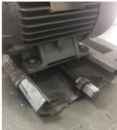
Figura 4.24: Riel guía de motor eléctrico.
