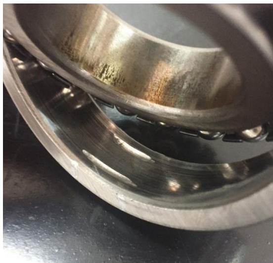
Figura 4.19: Acercamiento de falla longitudinal en la pista exterior.
