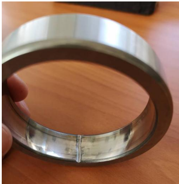
Figura 4.17: Ranura transversal mecanizada en la pista exterior del rodamiento.
