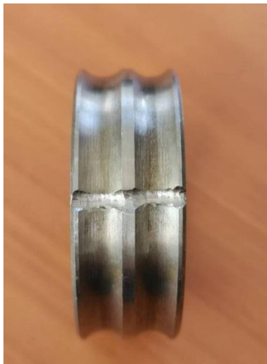
Figura 4.15: Falla mecanizada en el anillo interno del rodamiento.
