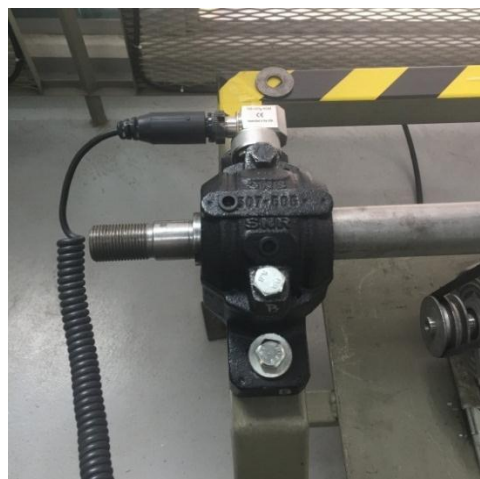
Figura 4.23: Descanso seleccionado para la toma de mediciones.
