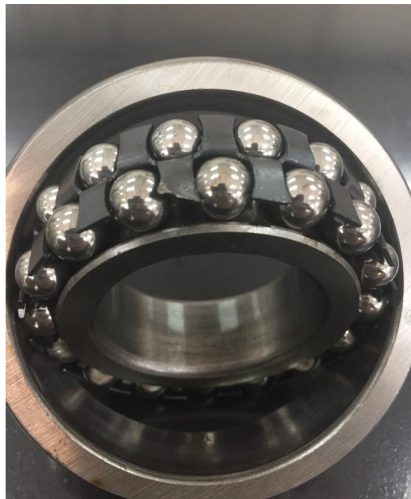
Figura 4.20: Falla en la jaula de sujeción.
