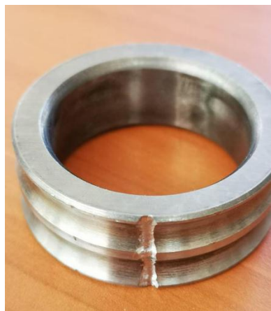
Figura 4.16: Segunda vista de falla en la pista interna.
