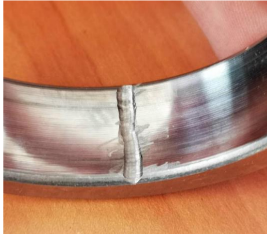
Figura 4.18: Acercamiento de falla transversal en la pista exterior.
