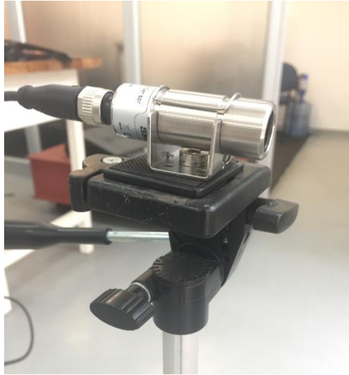
Figura 4.11: Tacómetro modelo CMAC 5030.
