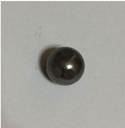
Figura 4.14: Elemento rodante mecanizado.
