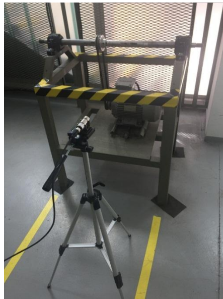
Figura 4.21: Tacómetro posicionado para la medición de revoluciones de giro del eje.
