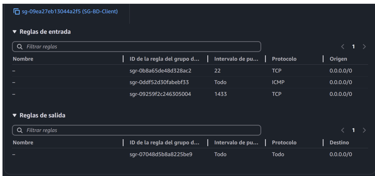
Figura 32: Reglas de grupo de seguridad adjuntas a instancia de base de datos cliente
