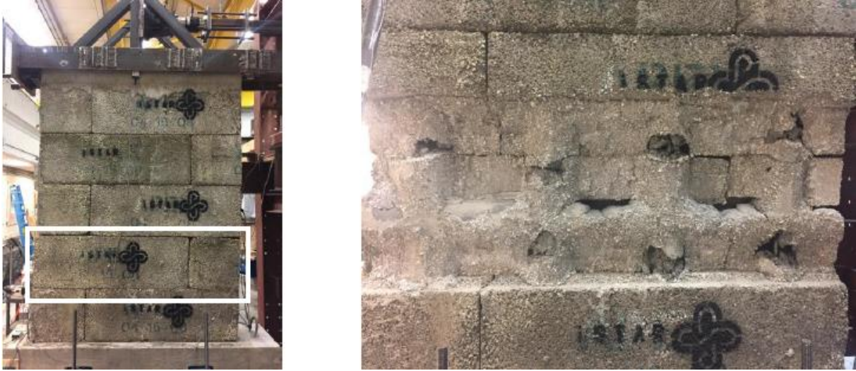
Figura 3.28. Falta de consolidación espécimen Wall-2 (Mohammed& Dusicka, 2018)
