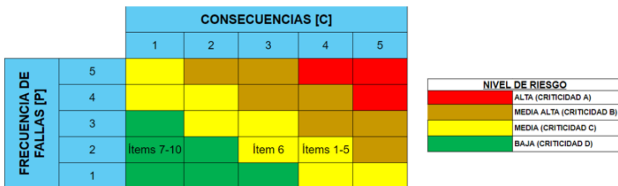
Figura 71: Matriz de Criticidad Válvulas de EBC.
