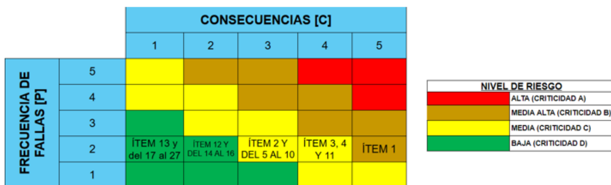
Figura 64: Matriz de Criticidad Válvulas de EDT.
