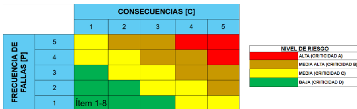
Figura 58: Matriz de Criticidad Válvulas de EM1B, EM2, EM3 y EM4.
