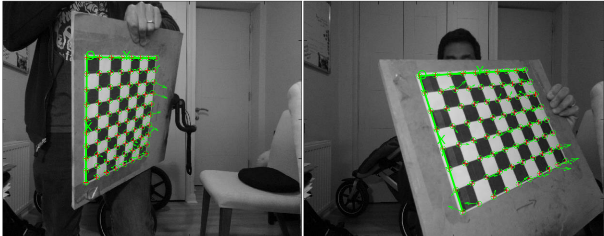
Ilustración 10: Tablero con patrón de ajedrez utilizado en la calibración de cámara dron Mavic Air 2, lado de cuadrado igual a 5 [cm]. Se muestran dos imágenes como ejemplo, en ellas se refleja la toma en distintas posiciones y orientaciones respecto del lente. Se muestran esquinas establecidas con “cruces” y las esquinas reproyectadas con “círculos”, las flechas denotan de diferencias entre los puntos reales y sus ubicaciones reproyectadas.
