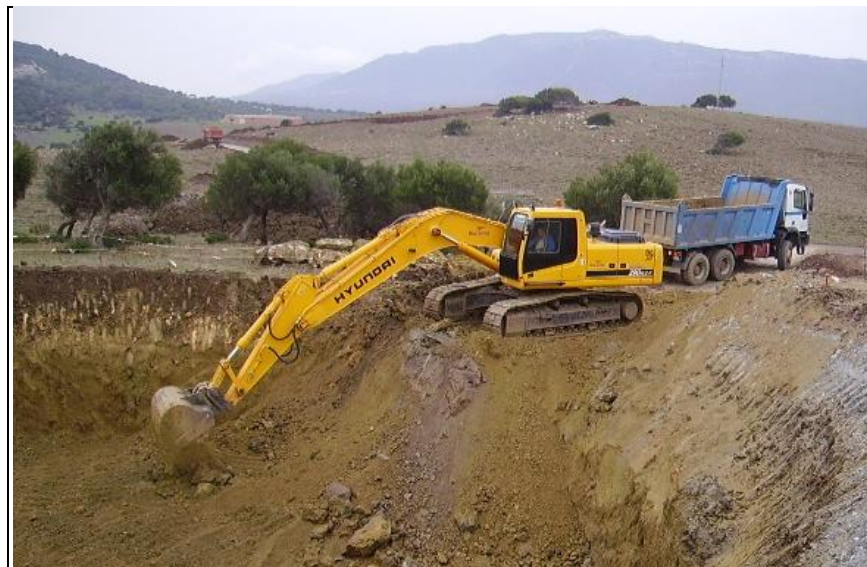
Figura 3-9: Sistema de carguío excavadora y camión tolva
