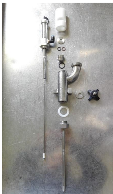
Ilustración 15: Despiece Boquilla Antigua
