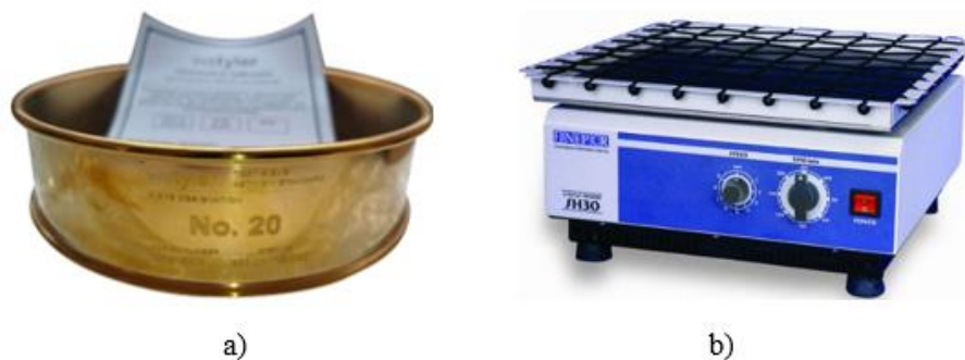
Figura 6 Equipos de clasificación de tamaño: a) Tamis W.S TYLER N°20 b) Shaker orbital FINEPCR modelo SH30
