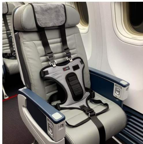
Ilustración 3.26: Prototipo cinturón tipo CARES para mascotas.
