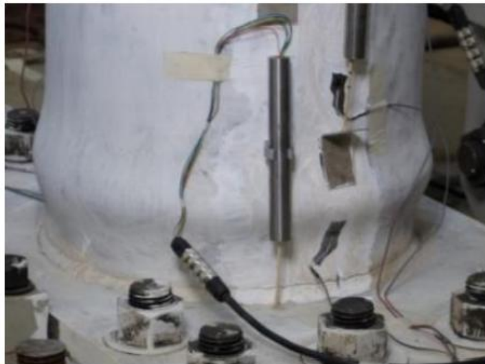
Figura 34. Registro fotográfico Memoria Alvaro Pezos Ensayo cíclico carga axial 50 toneladas
