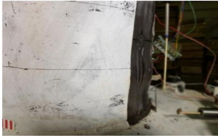
Figura 32. Registro fotográfico Memoria Alvaro Pezos Ensayo cíclico carga axial nula
