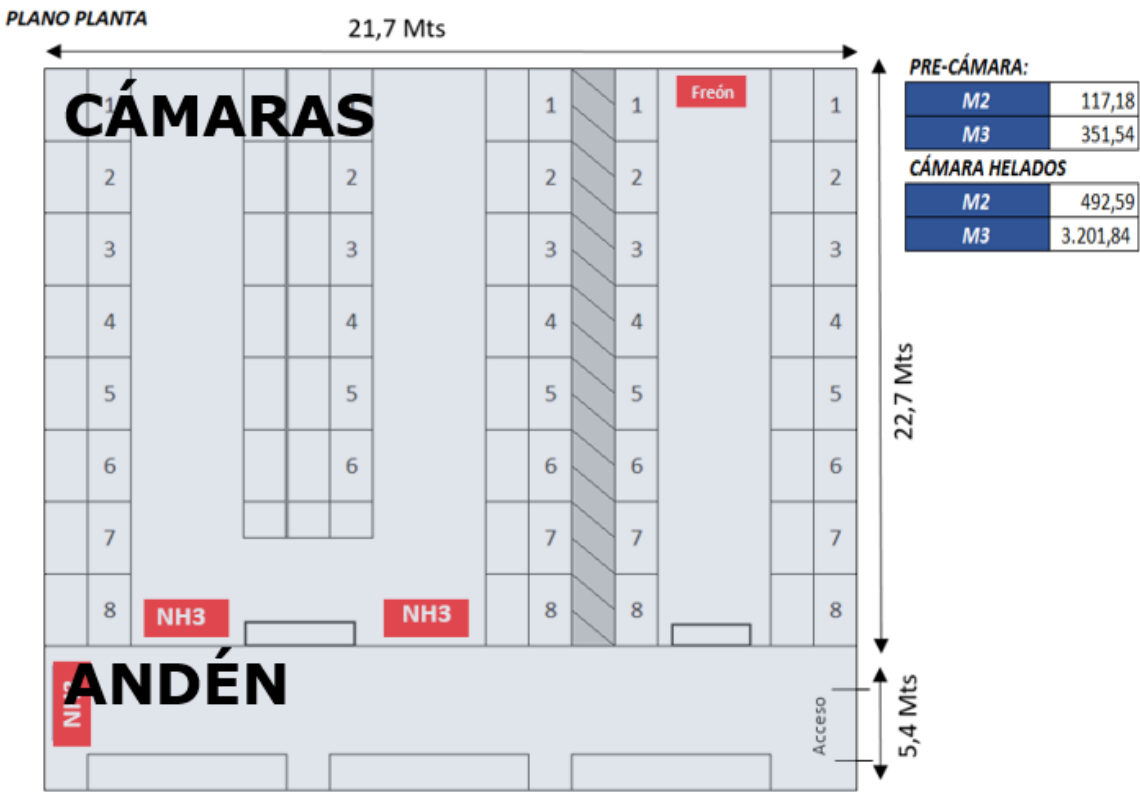
7Figura 3-6-2 Plano Cámara Congelados NESTLÉ CD CCP. Fuente: Servicio Técnico.
