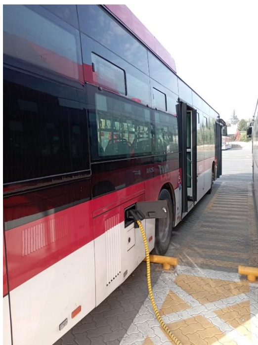
Figura 15: Conexión del cargador con el bus eléctrico [foto propia].
