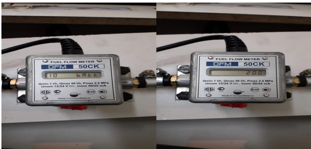
Figura 2-23. Pantalla N° 10 capacidad de batería integrada.
